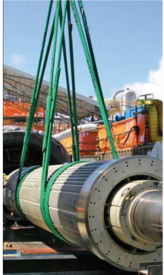
**Le funi Twin Path** hanno indicatori di sovraccarico, sono costruite con una doppia guaina di diverso colore e sono formate da due anelli separati. Pesano approssimativamente il 90% in meno rispetto ad un tirante in acciaio di pari portata. Hanno un allungamento inferiore all'1%. Se l'ergonomia, la produttività e la sicurezza sono importanti, allora le Twin Path sono la scelta migliore.
